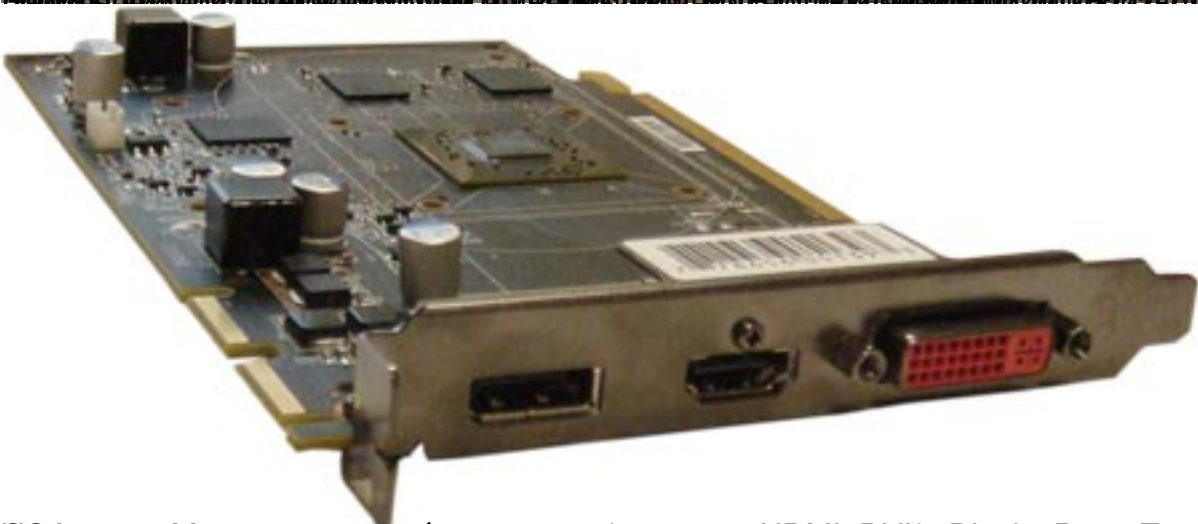
Видеокарта ATi Radeon 5670. Для подключения видеокарты к материнской плате необходимо вставить видеокарту в слот PCI Express. Для подключения видеокарты к монитору необходимо подключить кабель к разъему DVI или VGA на видеокарте.
